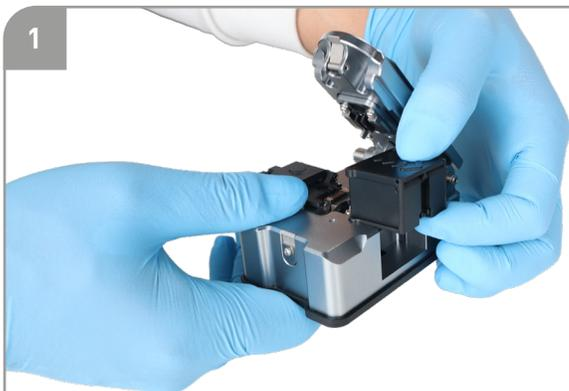
Colocar el contenedor sobre la posición de la cortadora.
